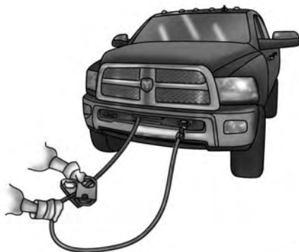
Acheminement du câble
