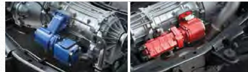
**CHOISISSEZ VOTRE CÔTÉ.** La prise de force Ram livre la marchandise. Prises de force livrables en option, illustrées sur la transmission automatique à 6 vitesses AISIN ultrarobuste. Prise bleue : châssis-cabine Ram 4500 4x2, avec prise de force montée à gauche. Prise rouge : prise de force montée à droite sur châssis-cabine Ram 4500 4x4 avec pompe hydraulique.
