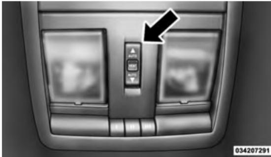
Commutateur de toit ouvrant à commande électrique
