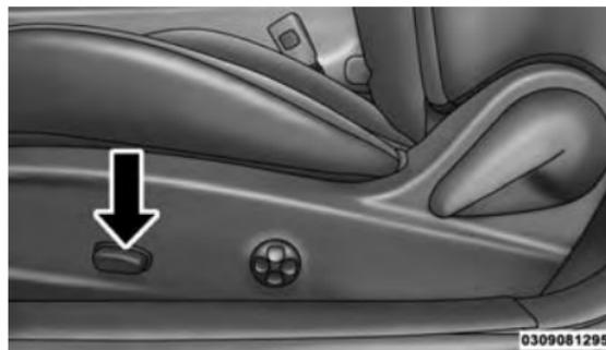
Commutateur de siège à commande électrique
