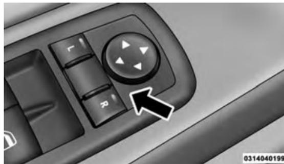
Commandes des rétroviseurs électriques
