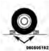
6. Calez l'avant et l'arrière de la roue diagonalement opposée à la position de levage. Par exemple, si vous changez le pneu avant droit, bloquez la roue
