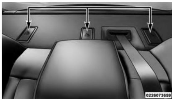
Ancrages de courroie d'attache
